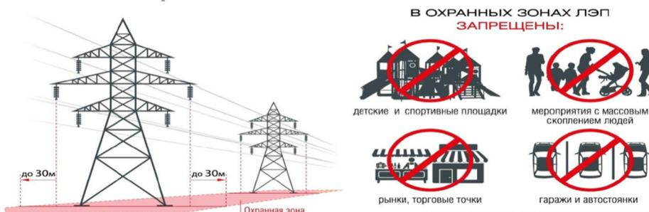
**В охранных зонах воздушных линий**, а именно в каждую сторону от крайних проводов: для **ВЛ 220 кВ - 25 метров**, для **ВЛ 500 кВ - 30 метров**, **ЗАПРЕЩАЕТСЯ** производить всякого рода действия, которые могут нарушить нормальную работу электрических сетей или привести к их повреждениям и повлечь причинение вреда жизни, здоровью граждан и имуществу физических или юридических лиц и в частности:
